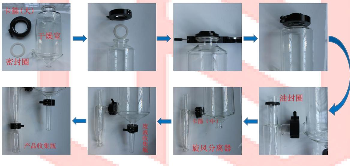
玻璃组件包含干燥室、旋风分离器、产品收集瓶、废液（料）收集瓶
